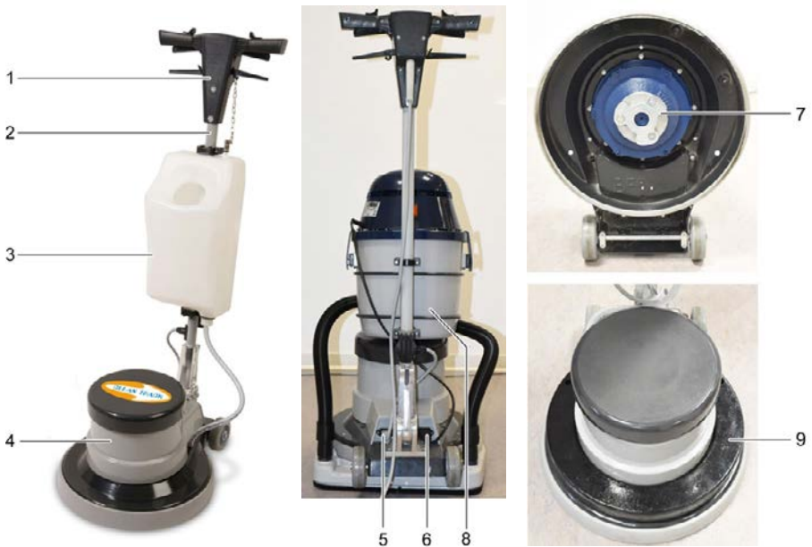
Abb. 7 1: Hauptkomponenten der Einscheibenmaschine (Bild Mitte: mit angebauter Sauggruppe)
